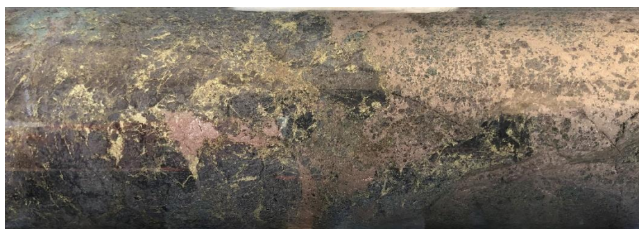
Figure 10. Pyrrhotite-Chalcopyrite mineralisation – HMKPDD002, 128.3m.
